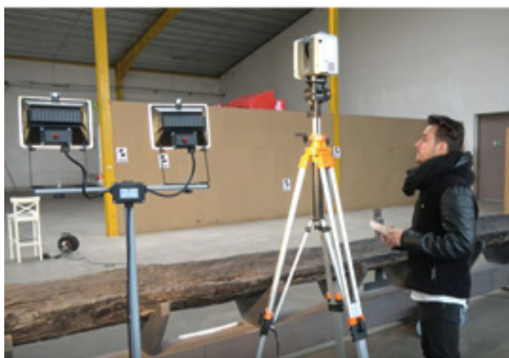
Digitale Vermessung für die 3D-Rekonstruktion. Digital surveying for 3D reconstruction.
