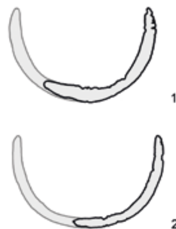
Rekonstruierte Rumpfschnitte: oben: direkt am Heck, unten: 5 m vor dem Heck. Reconstructed hull cross-sections: top: directly at the stern, bottom: 5 m in front of the stern.
