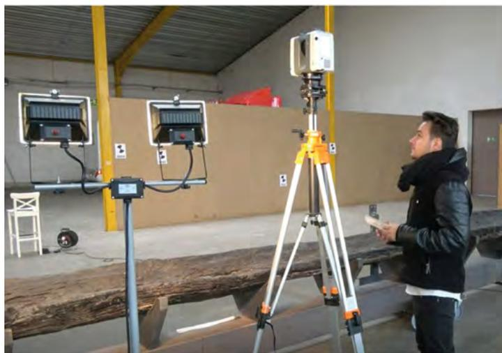
*Digitale Vermessung für die 3D-Rekonstruktion.
