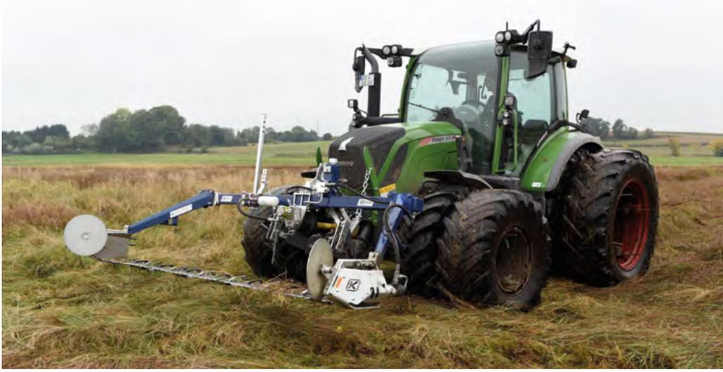
Speziell umgerüsteter Traktor mit mehrfacher Bereifung im nördlichen Federseeried, 2021.
