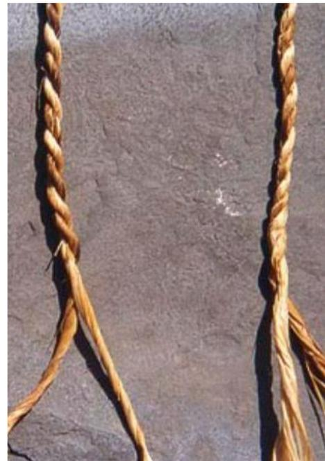
Abbildung 3: links S-Drehung und rechts Z-Drehung
